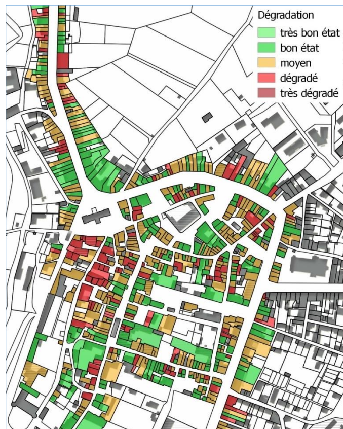
Etat de dégradation du bâti extérieur Source analyse de terrain SOLIHA, 2018
