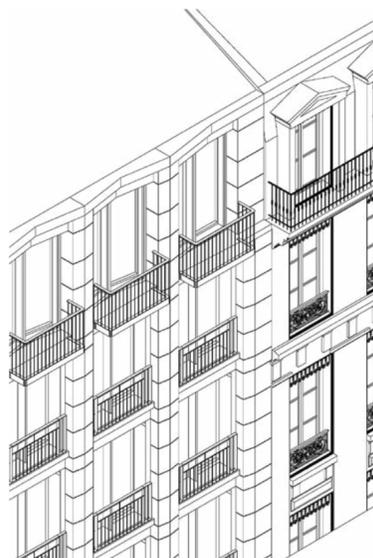
Détail du raccord à l'existant en partie haute de la façade sur rue
