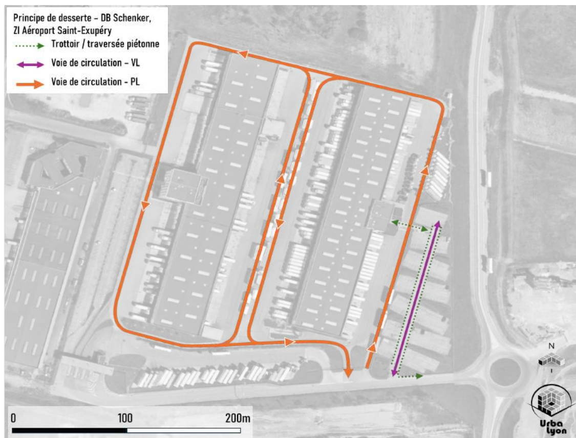
Site de DB Schenker, ZI Aéroport Saint-Exupéry : une desserte lisible du site logistique pour renforcer la sécurité des déplacements © Urbalyon
